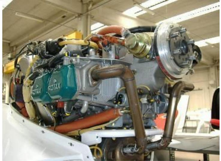
*la pompa olio e la pompa carburante*
